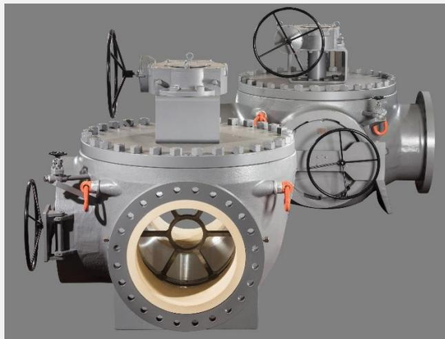
Las válvulas para raspadores pueden fabricarse con un bypass interno, que permite una continuación del flujo en la tubería durante la inserción del raspador. El flujo estará restringido a aprox. 25% del flujo nominal.
