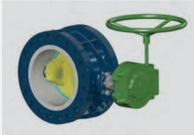
Las válvulas se pueden accionar manualmente con una palanca o con una caja de engranaje manual. El accionamiento con palanca está restringido a válvulas pequeñas con torque reducido, la fuerza manual que se puede aplicar en la palanca está condicionada.
