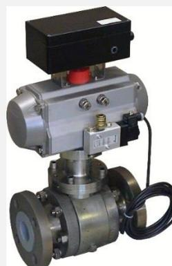
Los actuadores neumáticos se utilizan normalmente para válvulas pequeñas y de tamaño medio, donde el torque requerido no es tan alto. Así como también donde hay requerimientos de rapidez en cuanto al tiempo de operación y/o cuando además se necesita asegurar un sistema seguro ante la falla de suministro principal (aire) o una emergencia.
